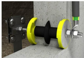
Erdungsdurchführung HEA-15-M12: auf der einen Seite Anschluss eines Flachstahls über Kreuzklemme Z-KG-M12 und auf der anderen Seite Anschluss eines Erdungsleiters über den Anschlussbolzen Z-B-M12.
